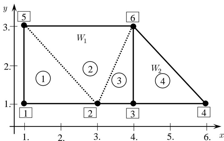
Рис.1. Пример сетки из треугольных элементов первого порядка
