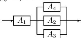
Вероятность выхода из строя элемента  $A_2$  равна 0,01, остальных элементов  $A_k$  — по 0,1. Предполагается, что элементы выходят из строя независимо друг от друга. Найти вероятность того, что цепь будет пропускать ток.
