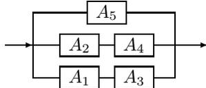
Вероятность выхода из строя элемента  $A_2$  равна 0,01, остальных элементов  $A_k$  — по 0,1. Предполагается, что элементы выходят из строя независимо друг от друга. Найти вероятность того, что цепь будет пропускать ток.
