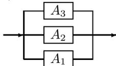
Вероятность выхода из строя элемента  $A_1$  равна 0,1, остальных элементов  $A_k$  — по 0,04. Предполагается, что элементы выходят из строя независимо друг от друга. Найти вероятность того, что цепь будет пропускать ток.
