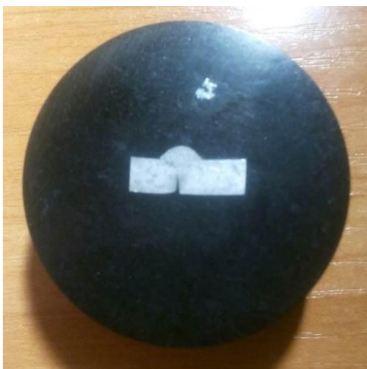
Рисунок 2. Микрошлиф сварного шва.
