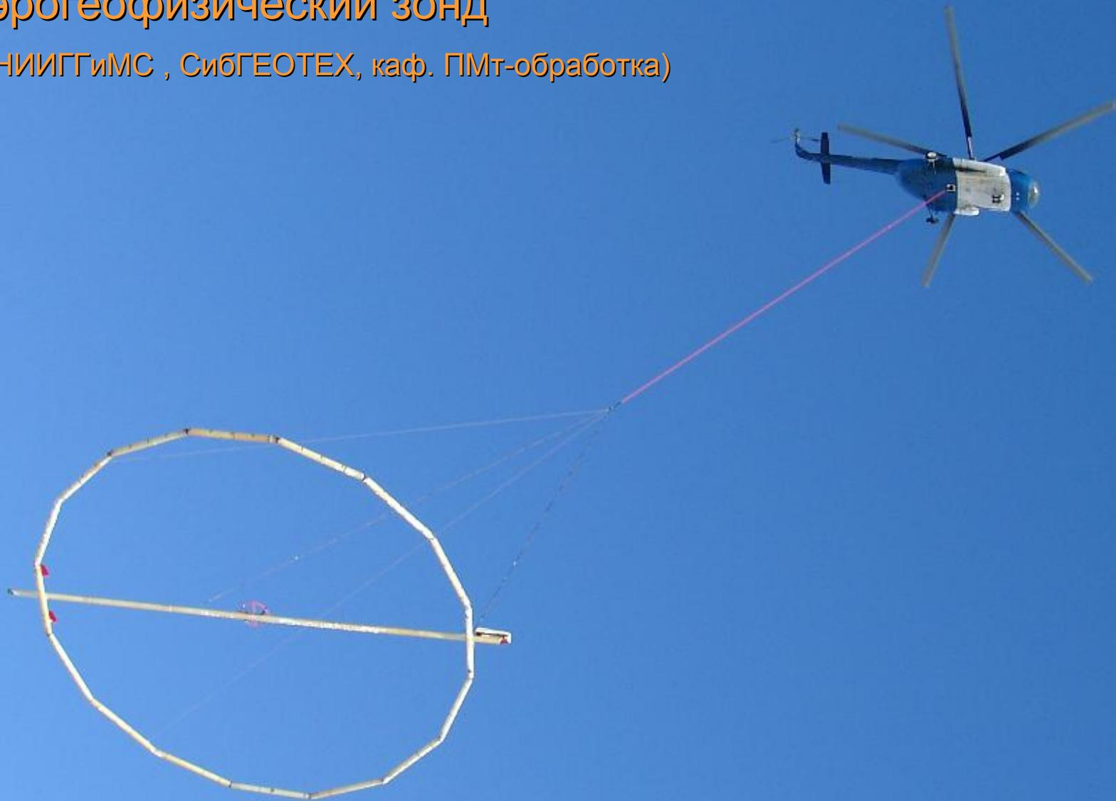
Проблемы: устойчивость полета, обеспечение прочности при ограничении на массу, минимизация лобового сопротивления
