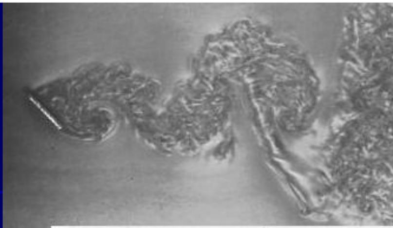
172. След за наклонной плоской пластинкой. След за пластинкой, обтекаемой под углом атаки  $45^\circ$ , турбулентен при числе Рейнольдса 4300. Алюминиевые хлопья, взвешенные в воде, выявляют характерную извилистую форму этого следа. [Santwell, 1981]. Воспроизведено с разрешения из Annual Review of Fluid Mechanics, Vol. 13, © 1981 by Annual Reviews Inc.
