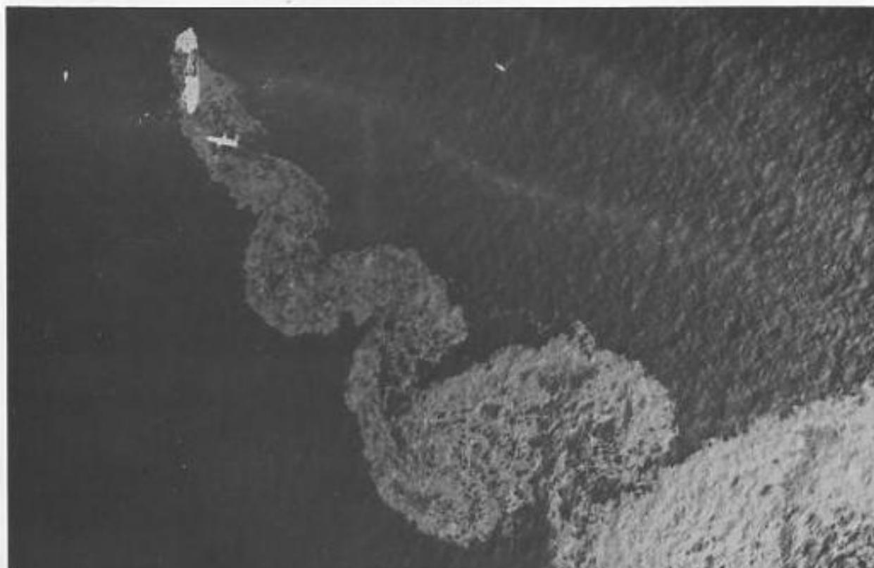
173. След за танкером, севшим на мель. Танкер «Argo Merchant» в 1976 г. сел на мель вблизи Нантакета. Вытекающая из него сырая нефть позволяет видеть, что судно оказалось наклоненным к морскому течению под углом  $45^\circ$ . Хотя число Рей-
