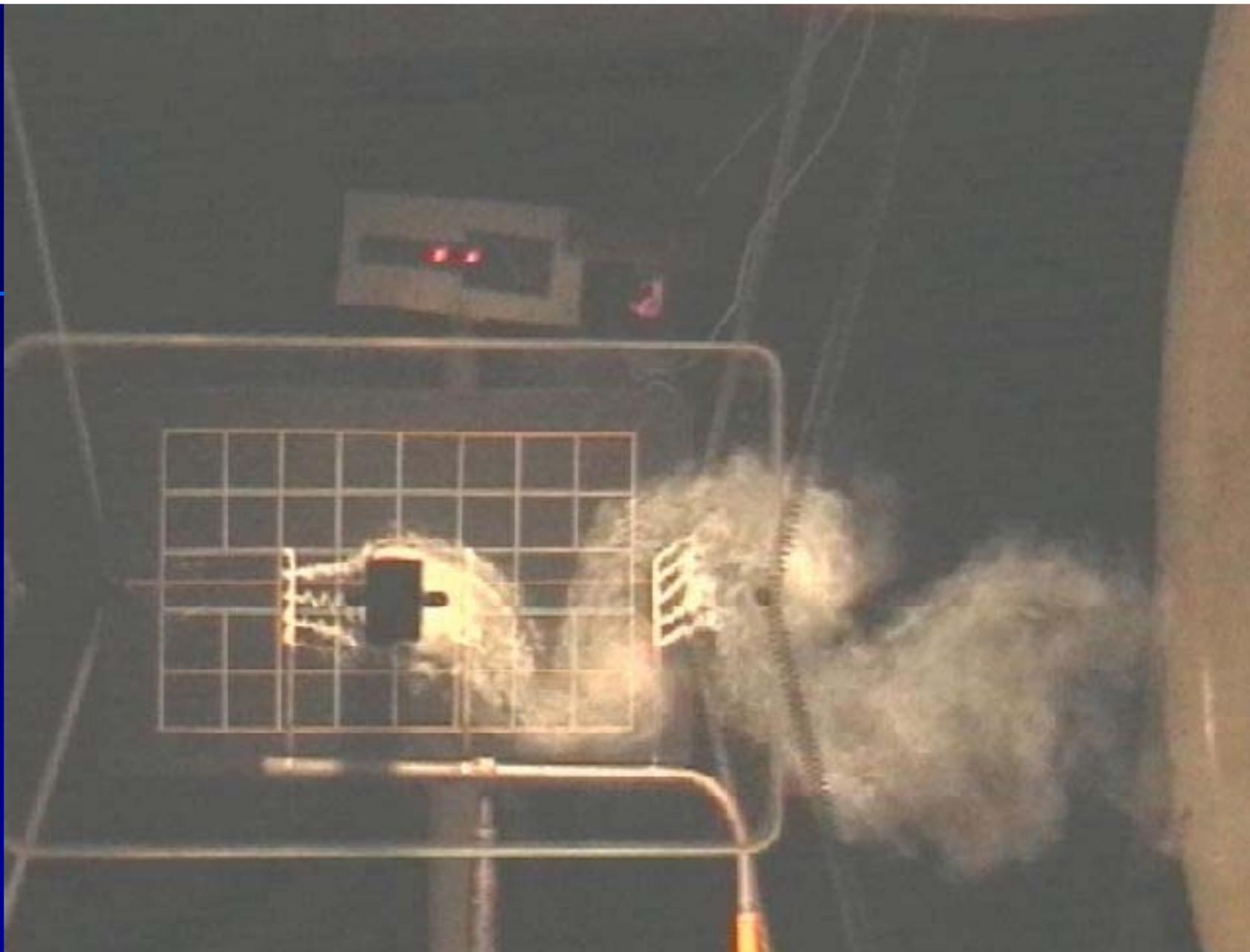
Визуализация течения при обтекании однобалочной конструкции
