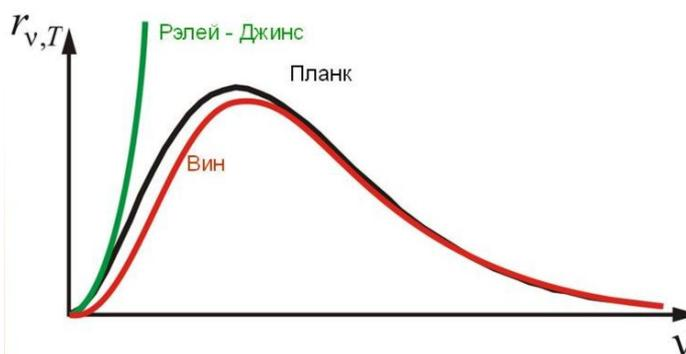
Рис. 4. Описание спектра излучения АЧТ формулами Вина, Релея-Джинса и Планка.
