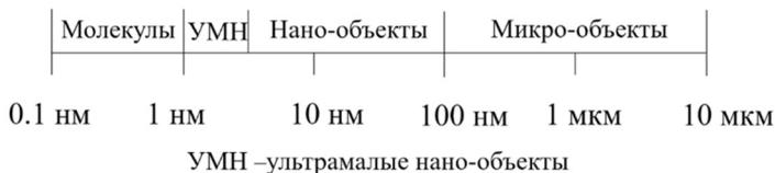
Рис. 1.1. Классификация частиц вещества по характерным размерам
