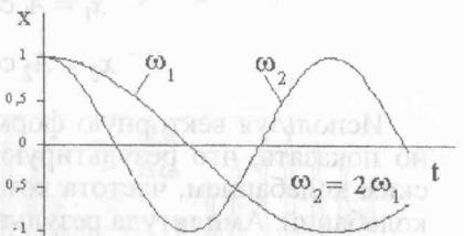
На нижнем рисунке представлены графики колебаний, у которых одинаковы амплитуды и начальные фазы, но различны частоты. Из графиков видно, что за время одного полного колебания с частотой  $\omega_2$  успеет произойти лишь половина полного колебания с частотой  $\omega_1$ . Следовательно,  $\omega_2 = 2\omega_1$ .
