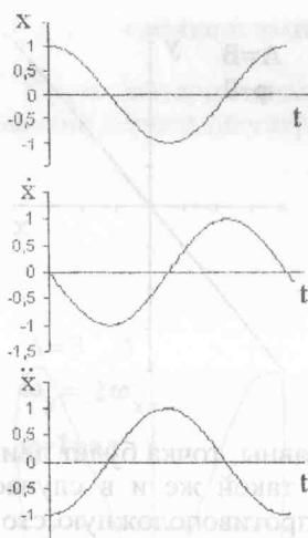
Пружинный маятник является гармоническим осциллятором, если у него нет потерь энергии. Циклическая частота собственных колебаний пружинного маятника  $\omega_0 = \sqrt{\frac{k}{m}}$ . Из этого выражения видно, что  $\omega_0$  растёт с увеличением упругости пружины и уменьшением массы груза.
