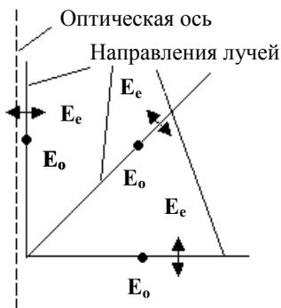
Второй луч называется **необыкновенным**, поскольку для него угол между направлением колебаний вектора  $\mathbf{E}_e$  (далее вектор  $\mathbf{E}$  необыкновенного луча будет обозначаться  $\mathbf{E}_e$ ) и оптической осью зависит от угла падения (см. рисунок). Следовательно, при разных углах падения он распространяется с разной скоростью и имеет разный показатель преломления, что, в общем, необыкновенно.
