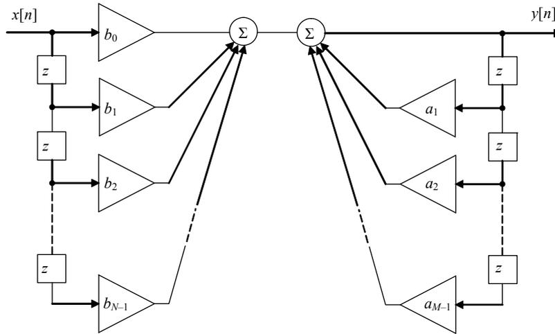
Рис. 3.4. Структура антикаузальной ЛИС-цепи конечного порядка
