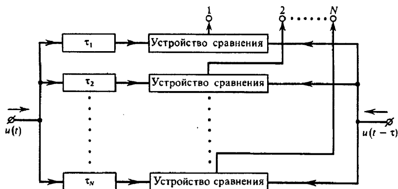
Рис. 3.3. Устройство для измерения времени задержки сигналов
