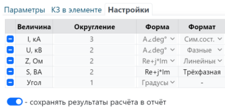
Рис. 3.8. Вкладка «Настройки» окна «Параметры элемента» элемента сети
