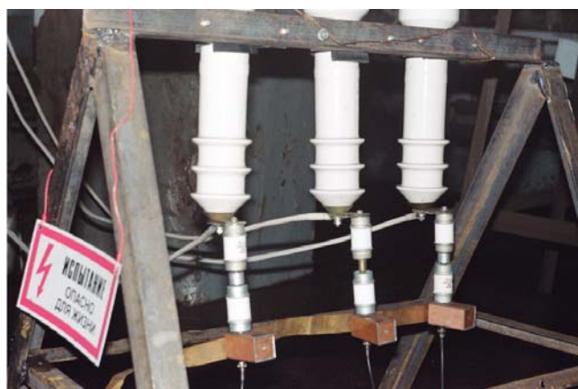
Рис. 8. Упрощенная схема измерения (а), подключение делителей к выводам ЭД (б)
