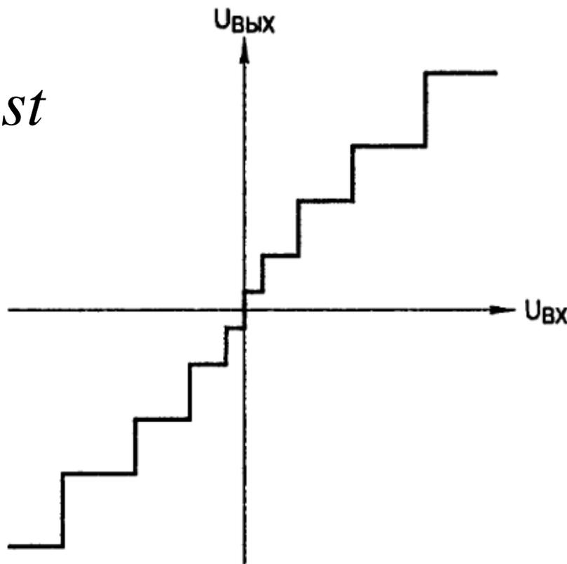
Неравномерная шкала квантования
