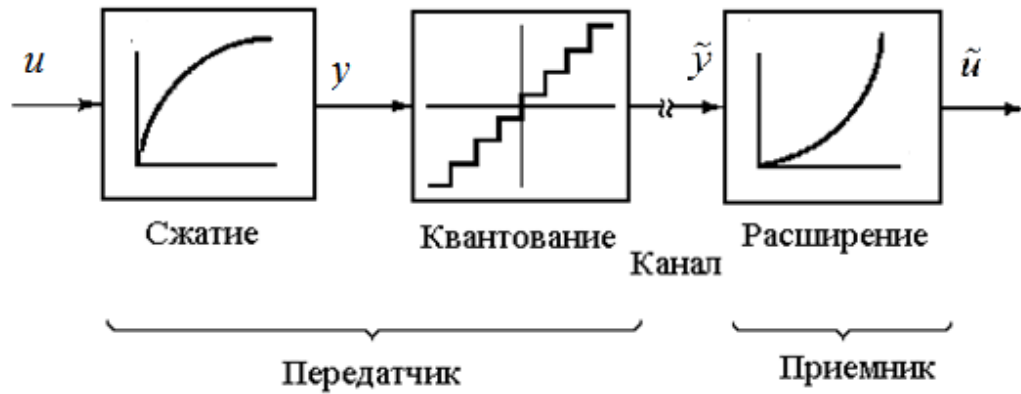
Рис.1.2. Структурная схема системы компрессор-экспандер
