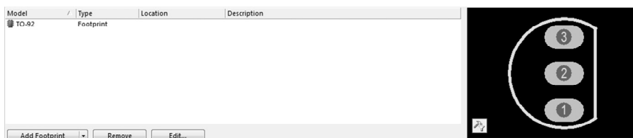
Рис. 2.19. Добавленная модель посадочного места компонента
