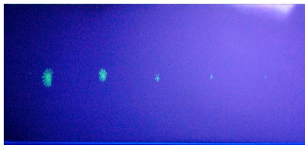
Рис. 2. Регистрация поверхностных дефектов под действием эксилампы
