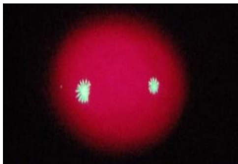
Рис. 1. Регистрация поверхностных дефектов под действием УФ облучателя на основе светодиода
