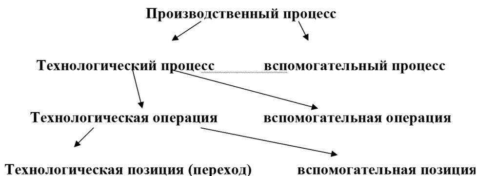
Технологическая операция - законченная часть технологического процесса, выполняемая на одном рабочем месте связанная с изменением формы и (или) свойств предмета труда. Вспомогательная операция - законченная часть технологического процесса, выполняемая на одном рабочем месте не связанная с изменением формы и (или) свойств предмета труда, но обеспечивающее более качественное выполнение основных технологических операций (мойка, правка)
