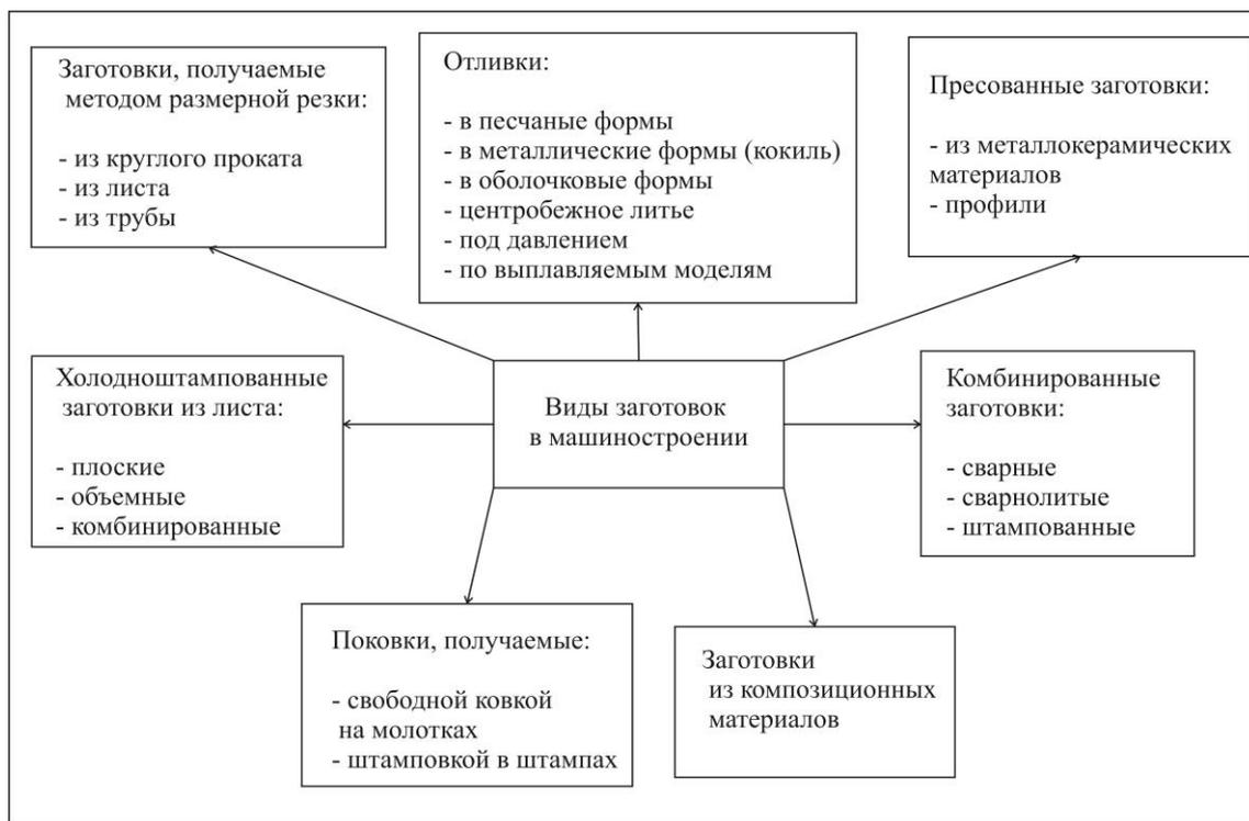
Рис. 4. Классификация заготовок
