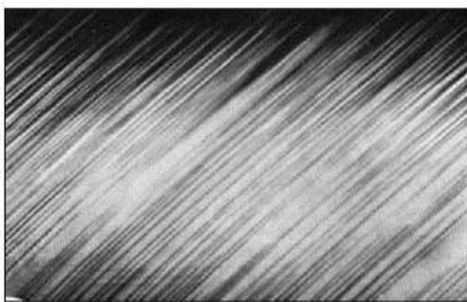
Рисунок 1.14 – Линии скольжения на поверхности пластически деформированного алюминия
