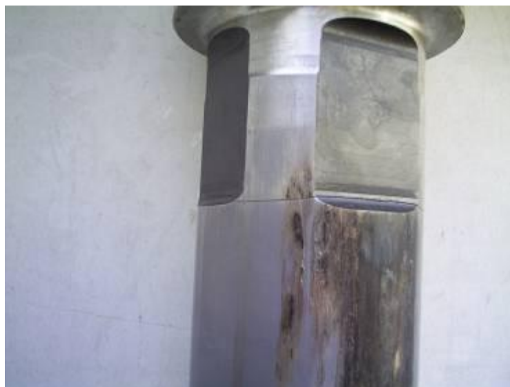
Рисунок 1.27 – Разрушение на макроскопическом уровне. Трещина в ударнике пневмопробойника
