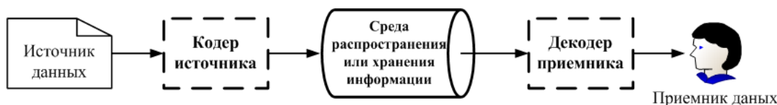
Рис. 3. Упрощенная структурная схема типичной системы передачи или хранения информации
