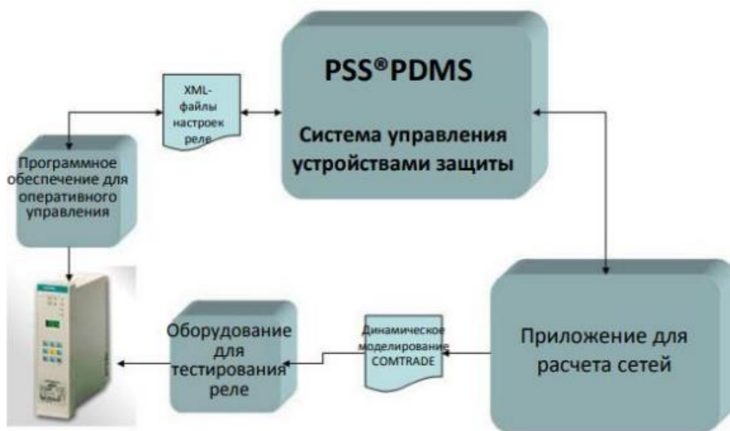
Рис. 1. Схема передачи данных об устройствах защиты
