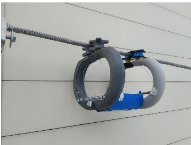
Рис. 1. Экспериментальный образец роботизированного комплекса для мониторинга ВЛЭП
