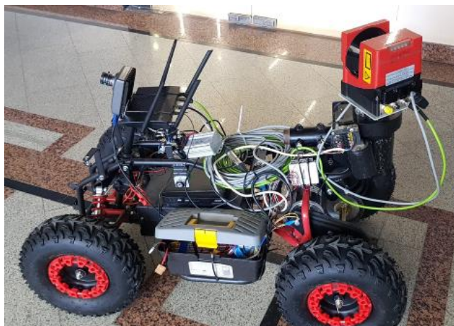
Рис. 1. Беспилотный квадроцикл для осмотра ВЛЭП
