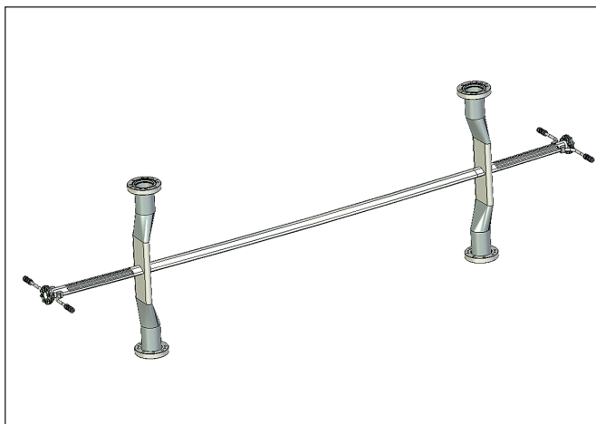
Рис.8. Вакуумная камера с малогабаритными портами откачки
