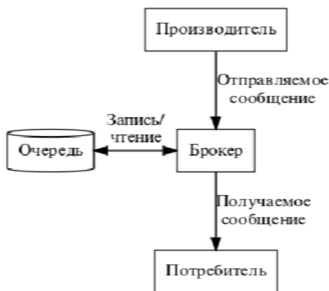
Рисунок 2 – Схема взаимодействия модулей с помощью брокера сообщений
