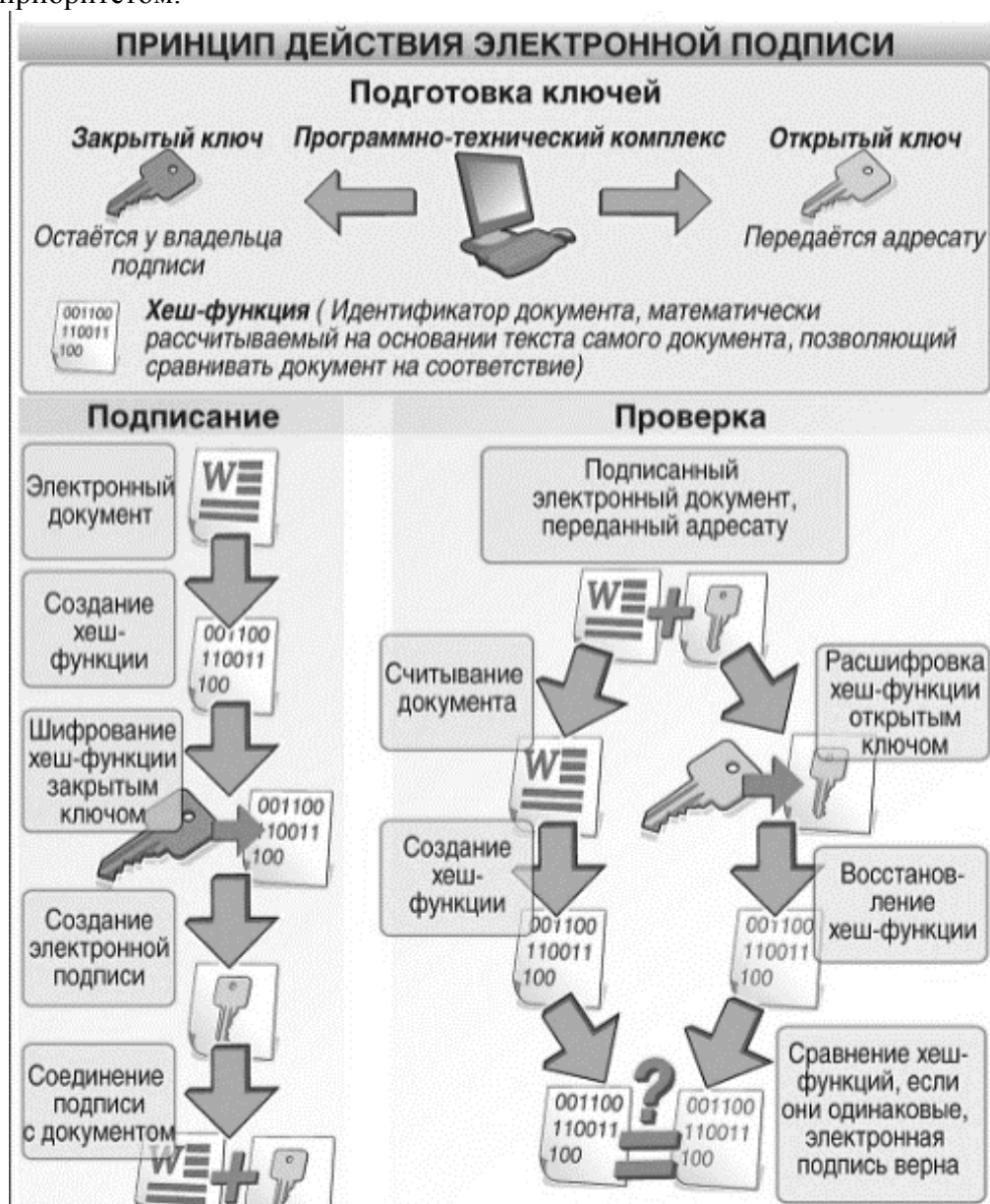
Рисунок 3 Принцип действия ЭЦП
