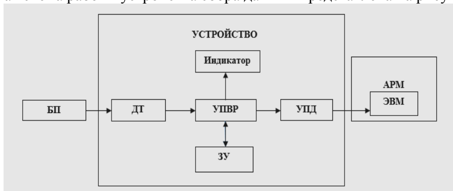
Рисунок 2 – Схема работы устройства сбора данных
