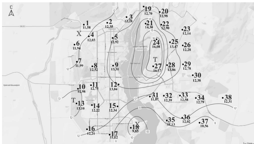
Карта-схема среднегодовых значений температуры подстилающей поверхности за день, полученных с помощью спектрорадиометра MODIS
