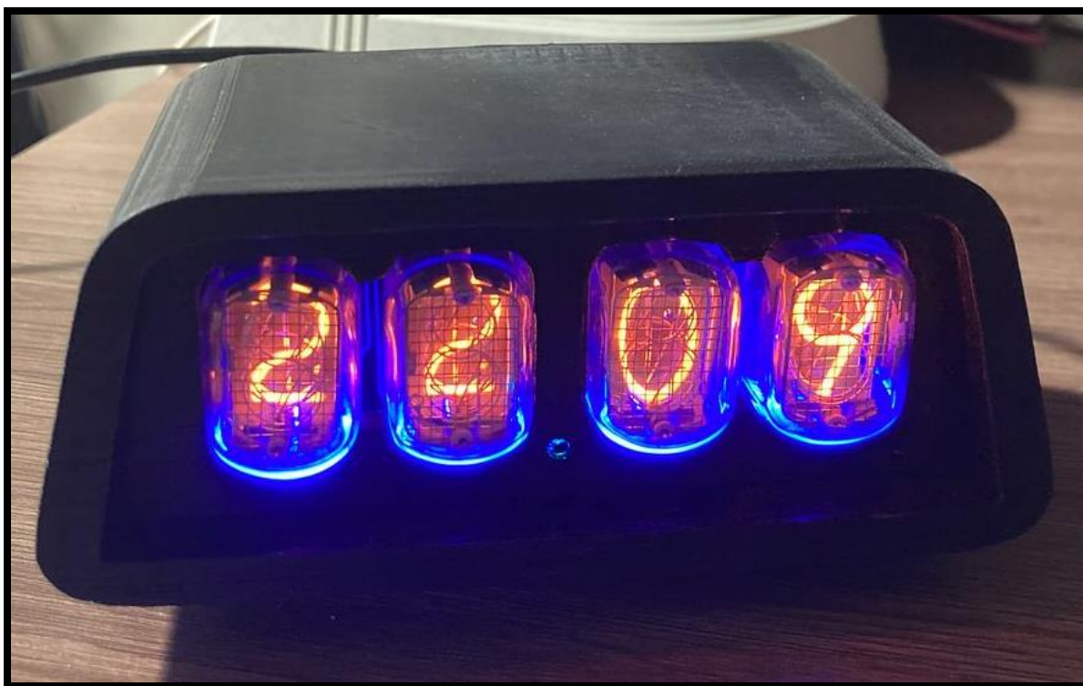
Рис. 2 – Итоговый вариант настольных часов на газоразрядных индикаторах
