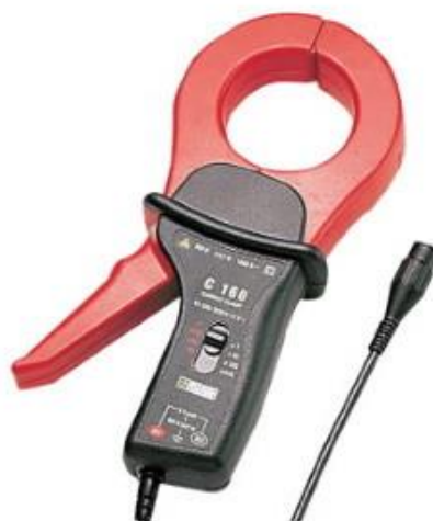
Рис. 3 – Оборудование для замера тока стартера
