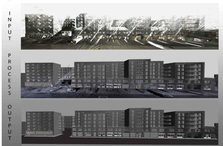
Рис.3 - Преобразование снимков с БПЛА в 3D модели
