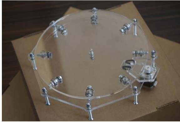
Рис/ 1 – Поворотный стол с фиксированными параметрами
