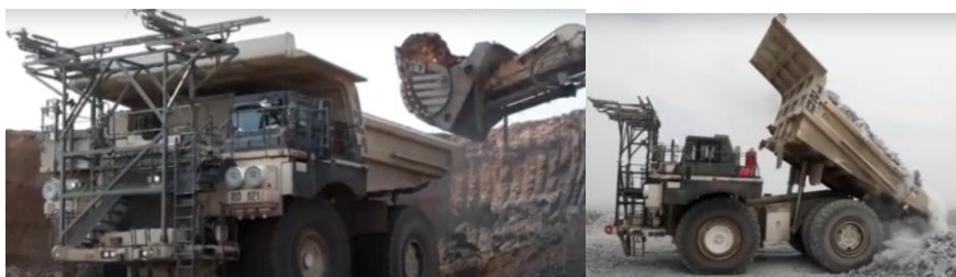
Рис. 3 – Дизель-троллейвоз Hitachi AC-3 в режиме дизеля
