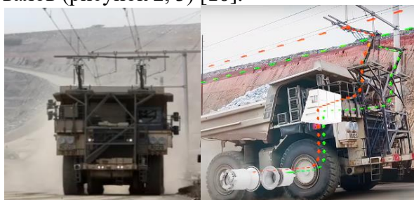
Рис. 2 – Дизель-троллейвоз Hitachi AC-3 в режиме троллей
