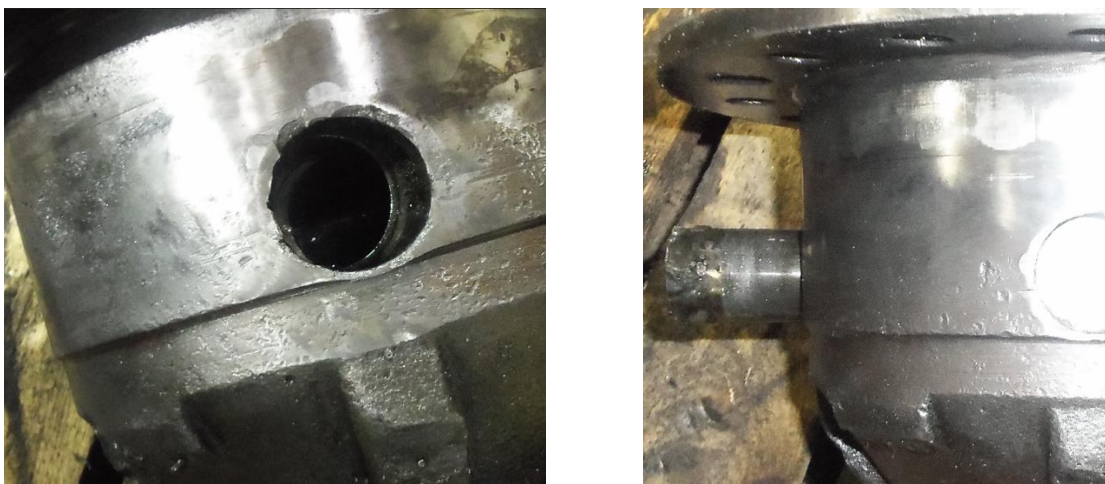
Рис. 6 – Следы некачественного ремонта дифференциала автомобиля
