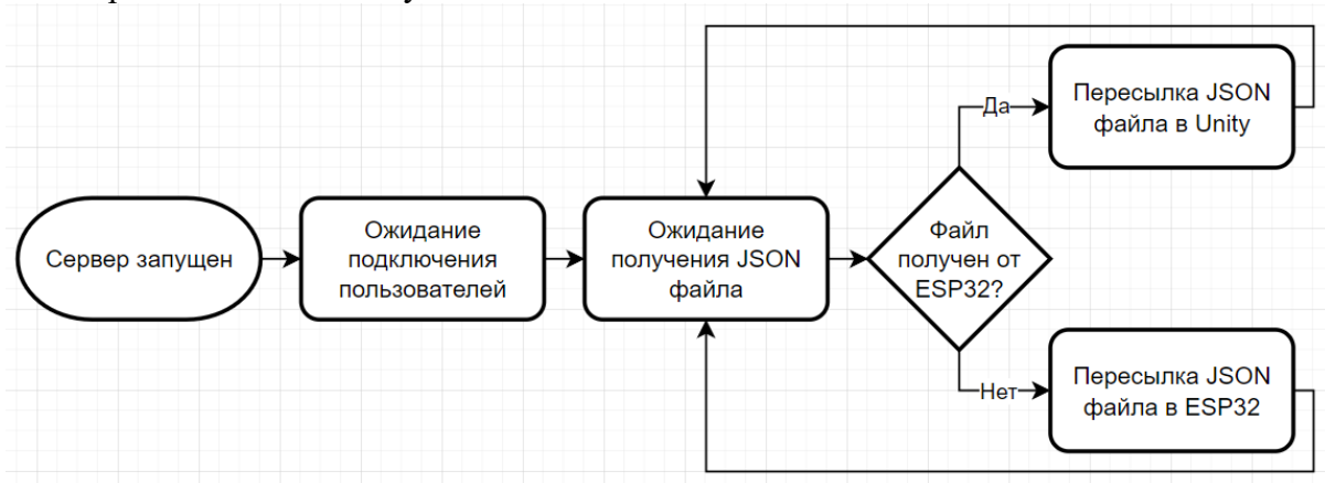
Рис. 2 - Схема работы сервера
