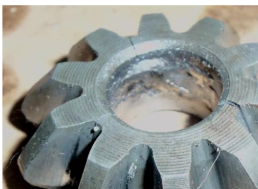
Рис. 2 – Дефекты и повреждения сателлитов дифференциала
