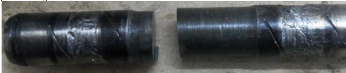
Рис. 1 – Дефекты и повреждения оси сателлитов дифференциала
