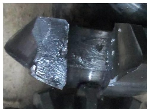
Рис. 2 – Дефекты и повреждения сателлитов дифференциала
