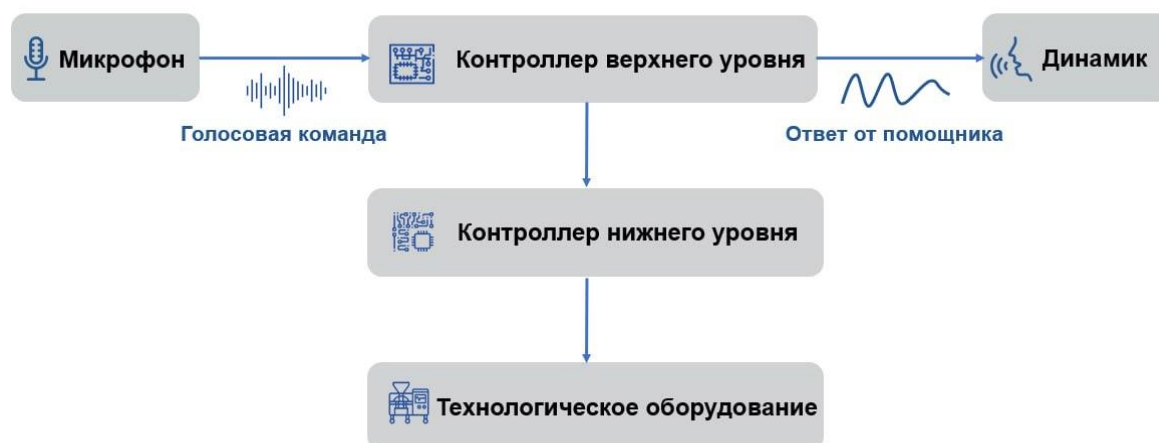
Рис. 2 - Функциональная схема автономной интеллектуальной системы распознавания голоса для управления технологическим оборудованием
