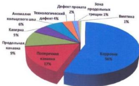
Рис. Классификация дефектов трубопровода
