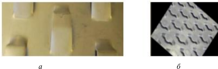
Рис.1. Фрагменты тарелок со стационарными клапанами АО ПО «Стронг»: а – с трапециевидными клапанами; б – с овальными клапанами
