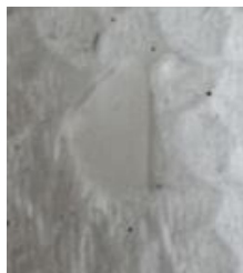
Рис. 4. Пленка АОА, полученная после погружения в 5 % раствор \text{H}_3\text{PO}_4 на 1 ч, (оптический микроскоп, увеличение x20)
