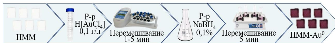
Рис. 2. Иммобилизация наночастиц золота в ПММ (ПММ-Au 0 )
