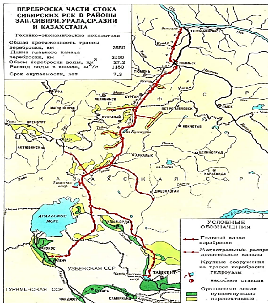
Рис. 2. Выбранная трасса канала «Сиб-Арал» по ТЭО 1978 г. [9]
