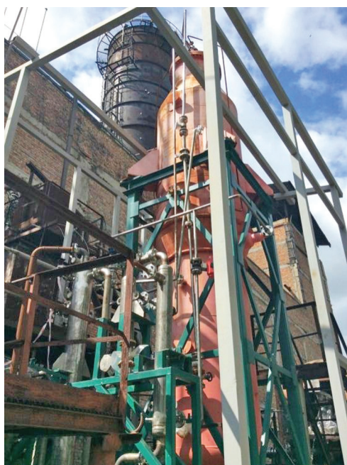
Рис. 3. Общий вид блока по производству метано-водородного топлива производительностью 1000 м 3 /ч
