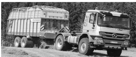
Рисунок 1. Автомобиль Mercedes-Benz класса Agrot truck ( a ), оборудованный трехточечным навесным устройством и ВОМ ( б ), в агрегате с прицепом-подборщиком Pöttinger Jumbo 8450.
