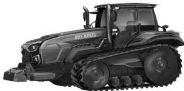
Рисунок. Серийный трактор Fendt 1100 Vario MT (а) и перспективный трактор «БЕЛАРУС 3503» (б) с гусеницами с треугольным обводом и нижним расположением ведущего колеса
