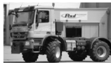
Рисунок 3. Сельскохозяйственные грузовые автомобили класса Agrot truck a – силосовоз GINAF с дистанционно регулируемым давлением воздуха в шинах; б – мультилифт Hover-Track с полугусеничным движителем; в – тягач Mercedes-Benz с шинами с рисунком протектора типа «елочка»
