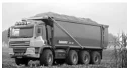
Рисунок 3. Сельскохозяйственные грузовые автомобили класса Agrot truck a – силосовоз GINAF с дистанционно регулируемым давлением воздуха в шинах; б – мультилифт Hover-Track с полугусеничным движителем; в – тягач Mercedes-Benz с шинами с рисунком протектора типа «елочка»
