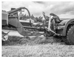
Рисунок 1. Автомобиль Mercedes-Benz класса Agrot truck ( a ), оборудованный трехточечным навесным устройством и ВОМ ( б ), в агрегате с прицепом-подборщиком Pöttinger Jumbo 8450.
