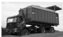
Рисунок 3. Сельскохозяйственные грузовые автомобили класса Agrot truck a – силосовоз GINAF с дистанционно регулируемым давлением воздуха в шинах; б – мультилифт Hover-Track с полугусеничным движителем; в – тягач Mercedes-Benz с шинами с рисунком протектора типа «елочка»
