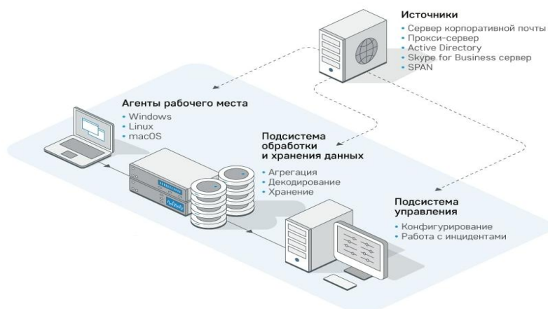
Рисунок 5 – схема системы DLP «Гарда Предприятие»
