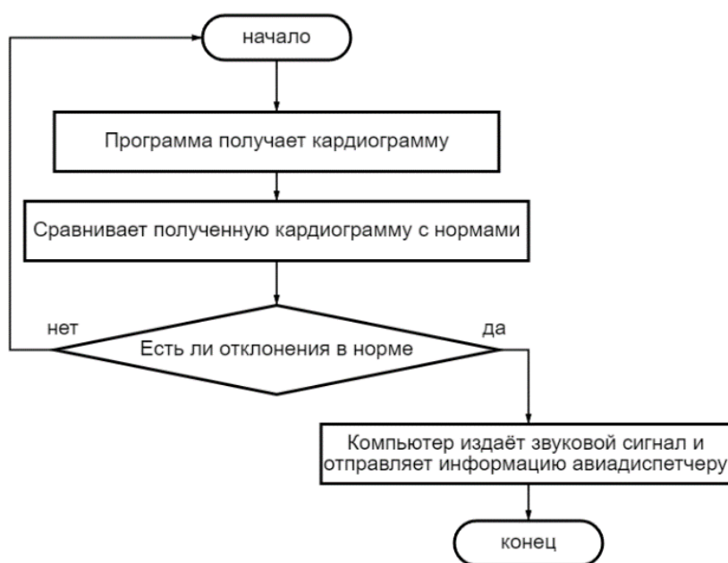
Рис. 4. Блок-схема интеграции в информационную бортовую систему.
