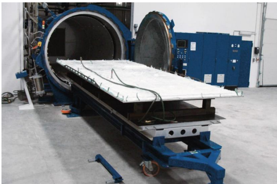
Рис. 2. Вакуумная камера для изготовления противоминной защиты MinePro днища танка «Leopard 2A6» [7]
