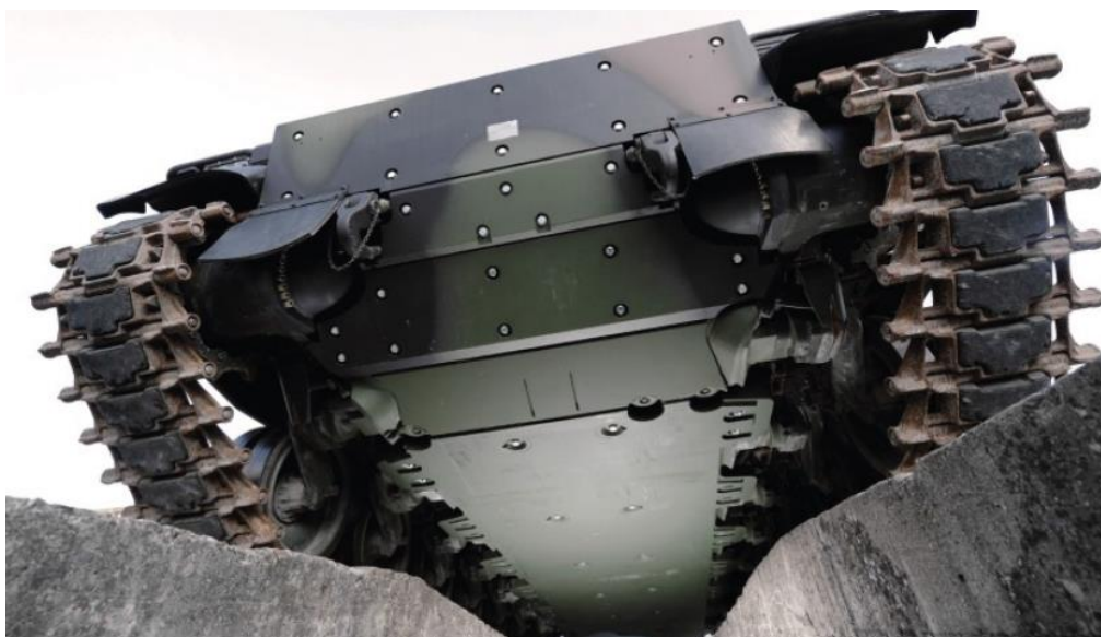
Рис. 1. Установка системы противоминной защиты MinePro на днище танка « Leopard 2A6 »
