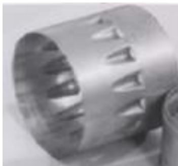
Рис. 3. Типовая трубчатая деталь с «жалюзи»
