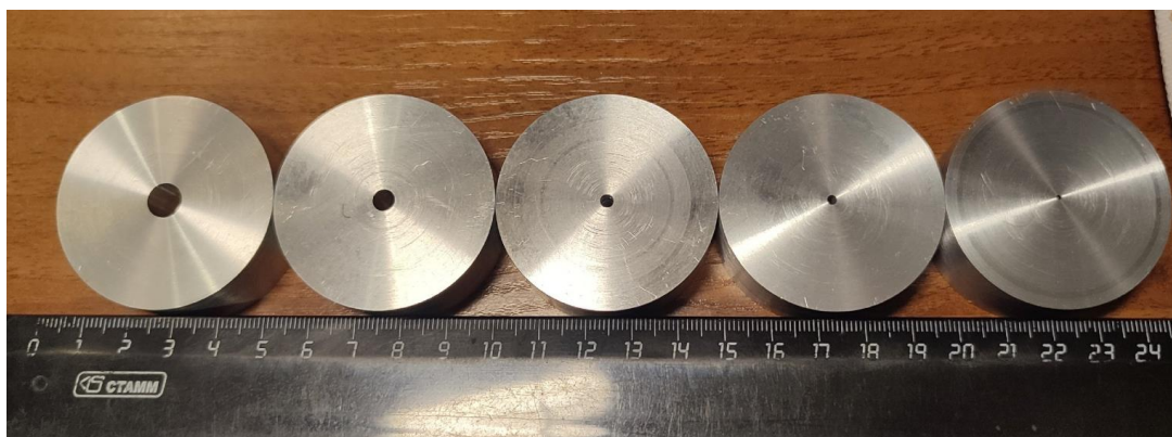
Рис. 2. Цилиндрические образцы из сплава Д16Т
