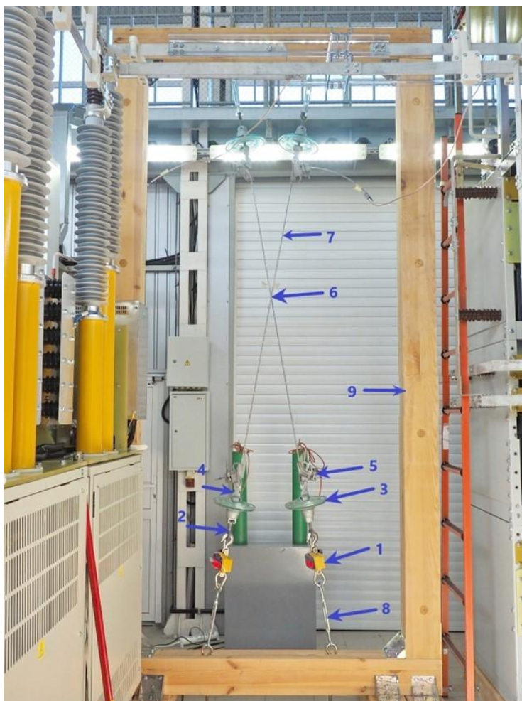
Рис. 1 Фотография установки. Компоненты установки: 1) Весы крановые электронные; 2) Серьга CPC 7-16; 3) Изолятор ПС-70; 4) Ушко У1-7-16; 5) Анкерные зажимы PAZ-3; 6) Место установки проволоки для обеспечения замыкания; 7) Исследуемые образцы (пара); 8) Талрепы; 9) Рама установки.
