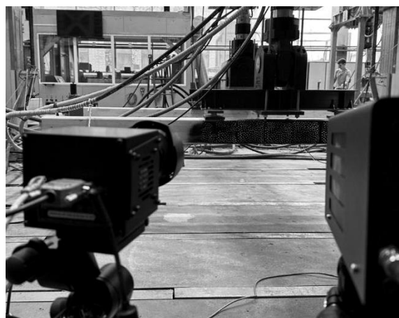
Рис. 1. Конфигурация системы съёмки: камера (слева), осветитель (справа), объект измерения (по центру).
