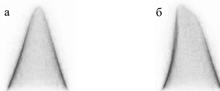
Рис. 1. Пример изображения конусного пламени при отсутствии электрического поля (а) и с электрическим полем напряженностью E=62.5 кВ/м (б).
