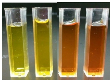
Рис. 2. Изменение цвета при образовании наночастиц меди
