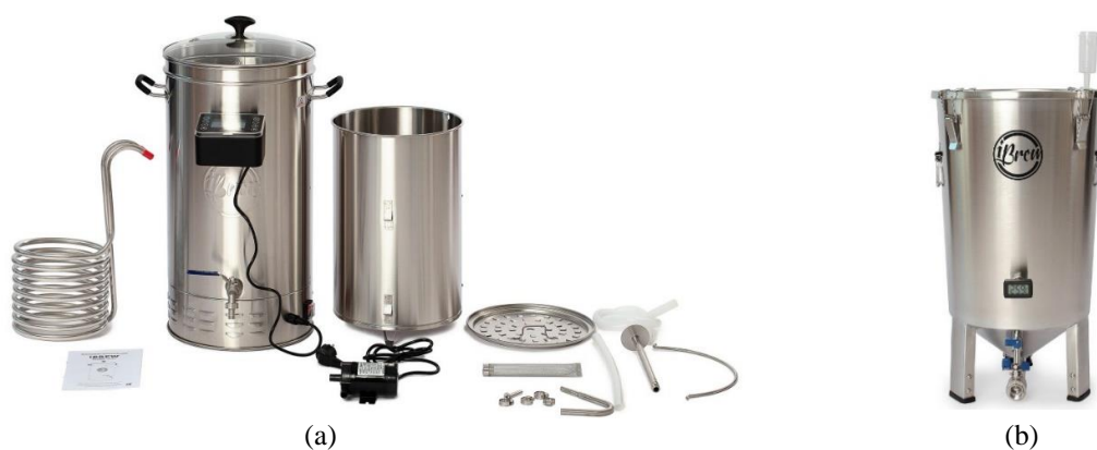
Рисунок 1. Лабораторная пивоварня настольного типа: (а) комплект оборудования для затирания, фильтрации заторной массы, кипячения и охлаждения пивного сусла; (б) аппарат для брожения и созревания
