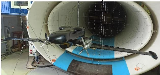
Рисунок 3 — Модель самолёта с моделированием СУ
