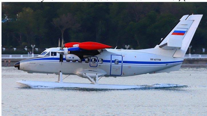
Рисунок 2 — Самолёт Л-410УВП-Е20-Д с поплавковым шасси
