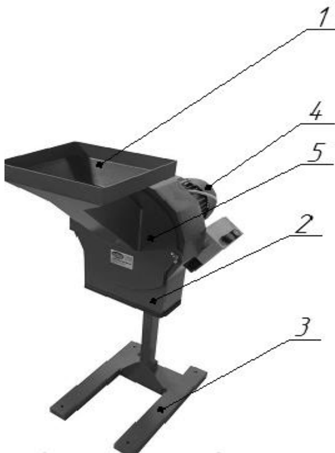
1 – бункер; 2 – кожух; 3 – основание; 4 – электродвигатель; 5 – ротор с молотками.
