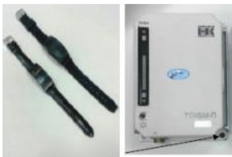
Рисунок 7 – Телемеханическая система контроля бодрствования машиниста.
