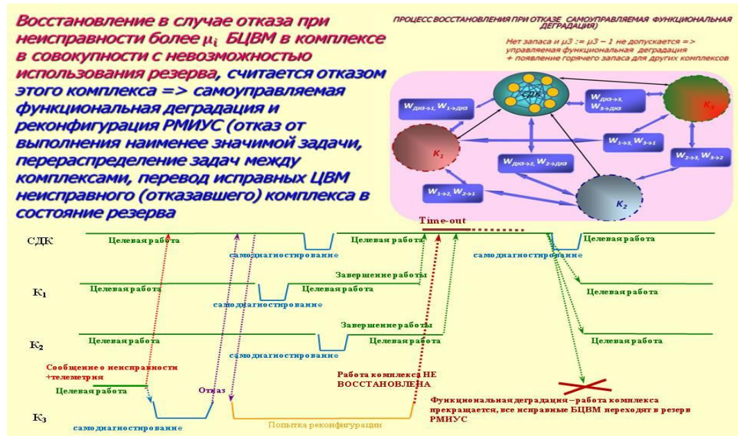
Рисунок 5 – Временная диаграмма процесса восстановления после сбоя (самоконтролируемая функциональная деградация)
