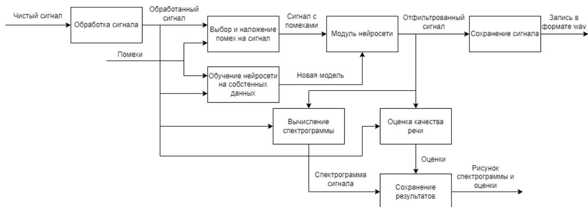
Рисунок 3 – Функциональная схема системы для исследования модели обработки и анализа сигнала.
