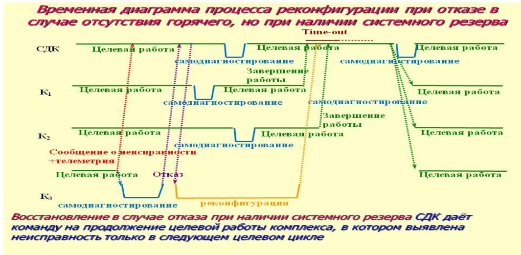
Рисунок 4 – Временная диаграмма процесса реконфигурации при отсутствии горячего, но при наличии резерва системы
