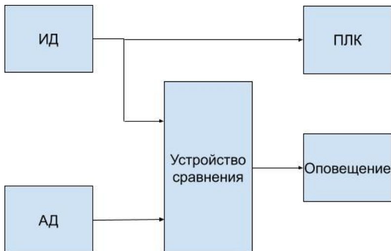
Рис 1. Функциональная схема устройства сравнения показаний датчиков
