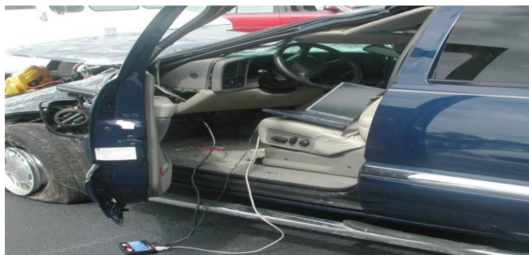
Рисунок 1 – Процесс считывания данных из MVEDR на месте ДТП.
