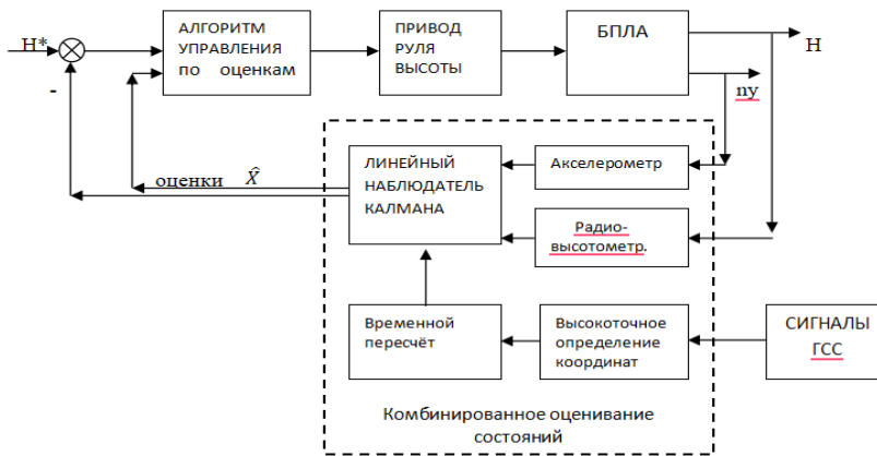
Рисунок 2 – Структурная схема алгоритмов оценивания состояния и управления
