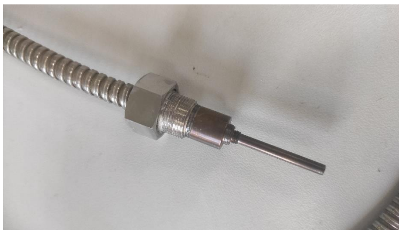
Рисунок 1 – Фото разработанного ВОДМП отражательного типа.
