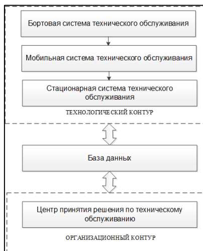
Рисунок 1 – Схема организационно-технического обеспечения эксплуатации ВС по техническому состоянию
