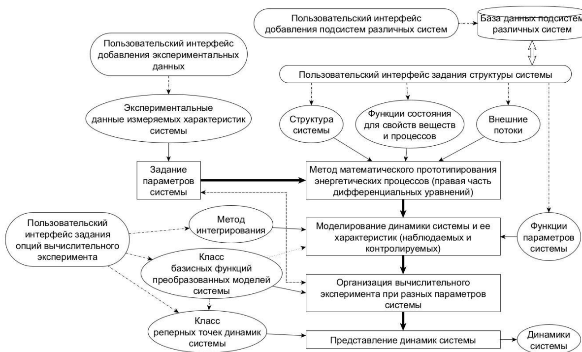
Рисунок 6 – Модуль расчета динамик пользовательской системы
