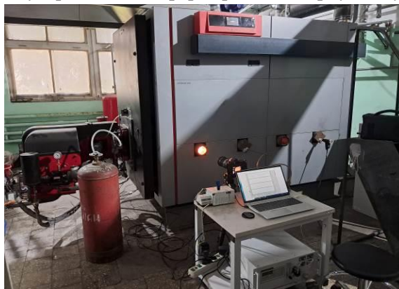
Рис. 1. Фотография крупномасштабного жидкотопливного огневого стенда ИТ СО РАН тепловой мощностью до 1 МВт.
