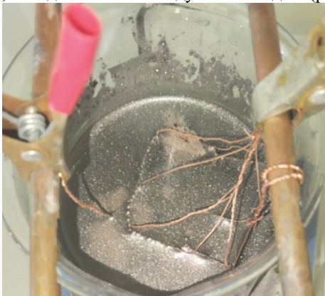
Рис. 2. Фотография процесса «уплотнения» частиц графена на поверхности раствора
