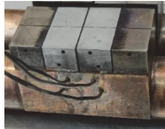
Рис. 1. Охлаждаемый вольфрамовый модуль облицовки дивертора ИТЭР с термопарами
