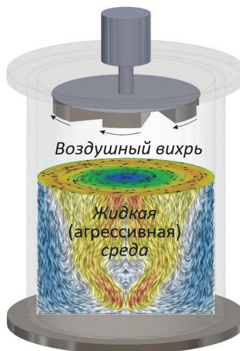
Рис. 1. Пример структуры вихревого течения культуральной среды в газовихревом биореакторе.
