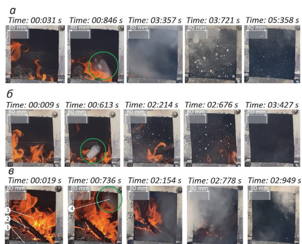
Рис. 2. Видеокadres процесса подавления возгорания гидратным огнетушащим устройством при варьировании массы гидрата: а – 35 г; б – 50 г; в – 70 г; 1 – корпус испытательного стенда; 2 – модельный очаг; 3 – пламя; 4 – гидратное огнетушащее устройство.
