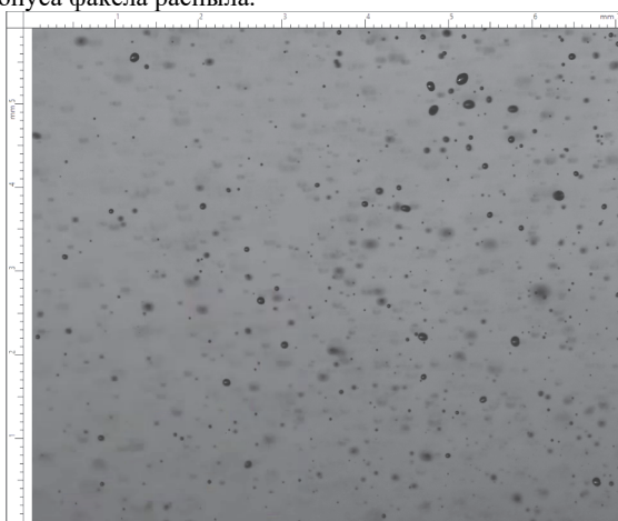
Рис. 3. Сформированный мелкодисперсный распыл на расстоянии 30 мм от среза форсунки.
