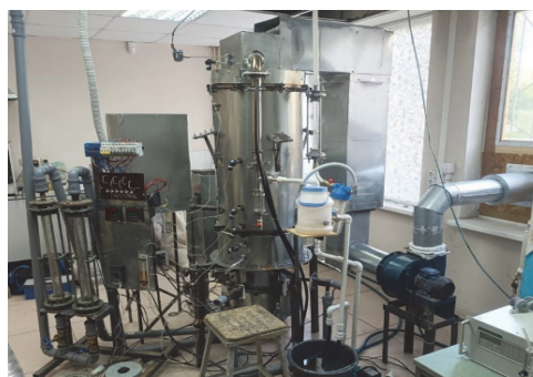
Рис. 1. Опытный образец поточного газификатора для выработки синтез-газа
