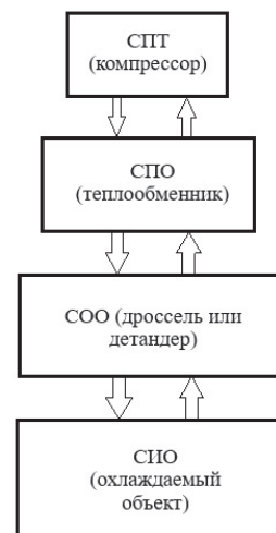
Рис. 2 Структура криогенной установки общий вид
