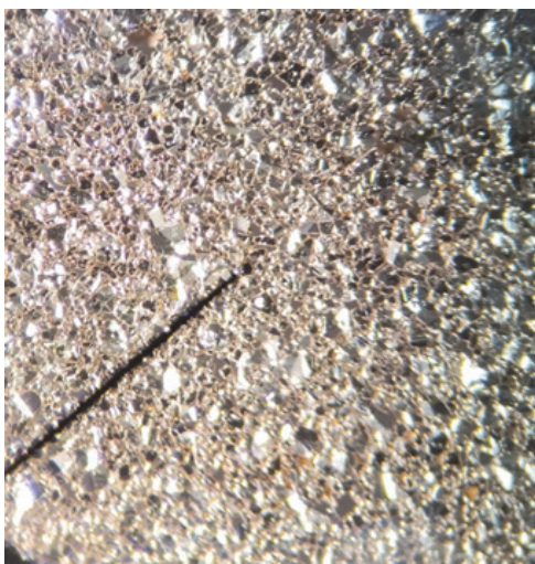
Рис. 3. Морфология поверхности полученной медно-графеновой пленки (100x увеличение)
