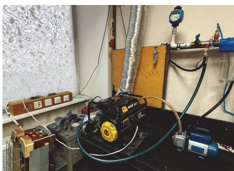
Рис. 2. Исследуемая мини-электростанция на базе поршневого двигателя, работающая на разных видах газообразного топлива
