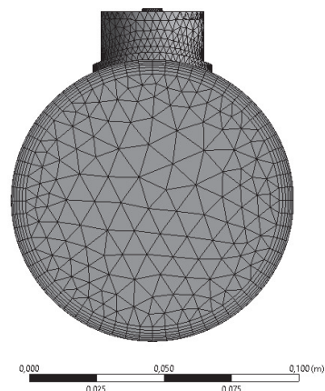
Рис. 2. Визуализация расчетной сетки канала основного потока аэросмеси.
