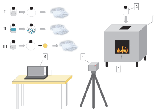
Рис. 1. Схема стенда: 1 – корпус; 2 – огнетушащее устройство; 3 – очаг; 4 – видеокамера; 5 – персональный компьютер.
