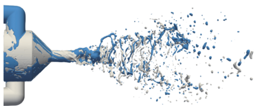
Рис 4. Визуализация истечения из форсунки во внешнюю область. Голубым цветом обозначена вода, белым – масло
