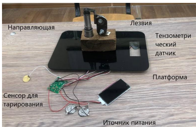
Рис. 1. Установка для определения силы приложенной к плодоножке плода при срезе.
