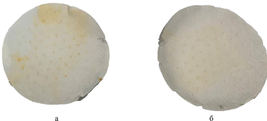
Рис. 4. Характерный внешний вид фильтра после процесса фильтрации ^ а – экспериментальный образец; б – Broad Spectrum Microtabs II
