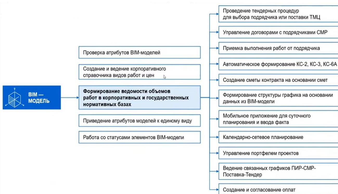
**Рис. 2. Пример схемы связей между процессами, производимыми при реализации инвестиционно-строительного проекта**
