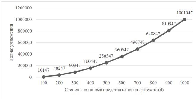
Рис. 3. Зависимость количества операций умножения от степени полинома представления шифртекста при расшифровании
