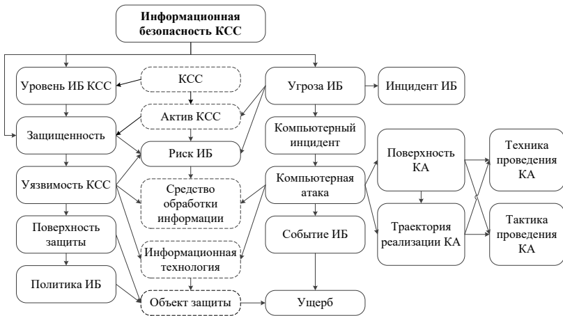
Рис. 1. Система терминов, описывающих обеспечение ИБ корпоративной сети связи
