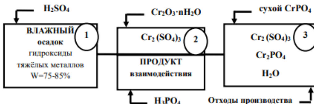
Рис. 1. – Схема получения неорганического клея из осадка гидроксидов тяжелых металлов, серной и фосфорной кислот
