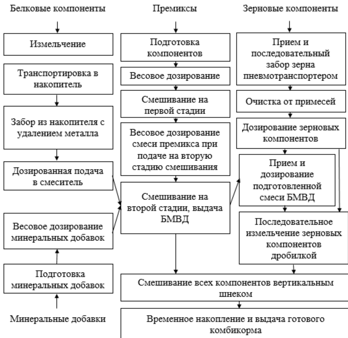
Рис. 1. – Схема операций изготовления комбикорма с трехстадийным смешиванием
