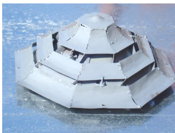
Рис. 2. – Общий вид конусов предварительной сепарации зерна
