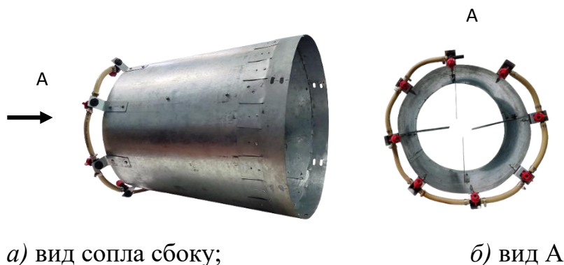
Рис. 2. – Общий вид сопла с комплектом щелевых распылителей жидкости на образующей сопла
