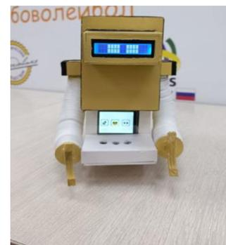
помощи составных частей созданных из ПВХ пластика. Руки робота выполнены из сантехнической трубы.
