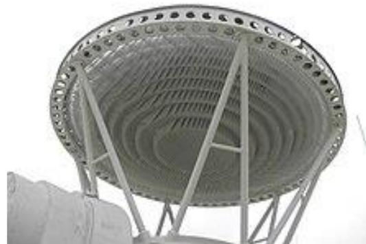
**Рисунок 4** – Линзовая антенна радиостанции Р-431-АМ
