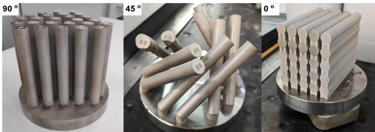
Рисунок 1. Образцы, полученные при различных углах выращивания 0°, 45°, 90° относительно направления теплоотвода.
