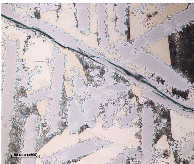
Рисунок 1. Структура сплава Al_{66}Cu_{24}Ni_{10} , полученная при охлаждении от 1400^{\circ}C со скоростью 100^{\circ}C/мин при нормальном давлении.
