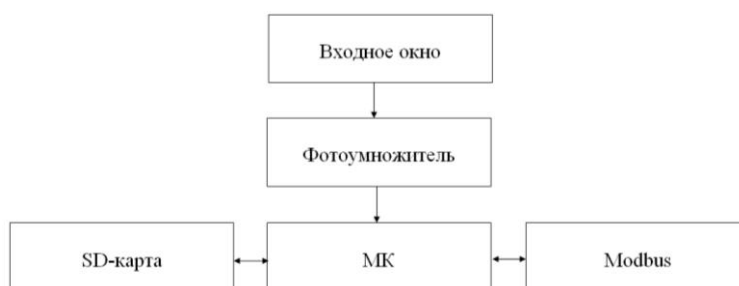
Рис. 3. Структурная схема устройства контроля подледной освещенности
