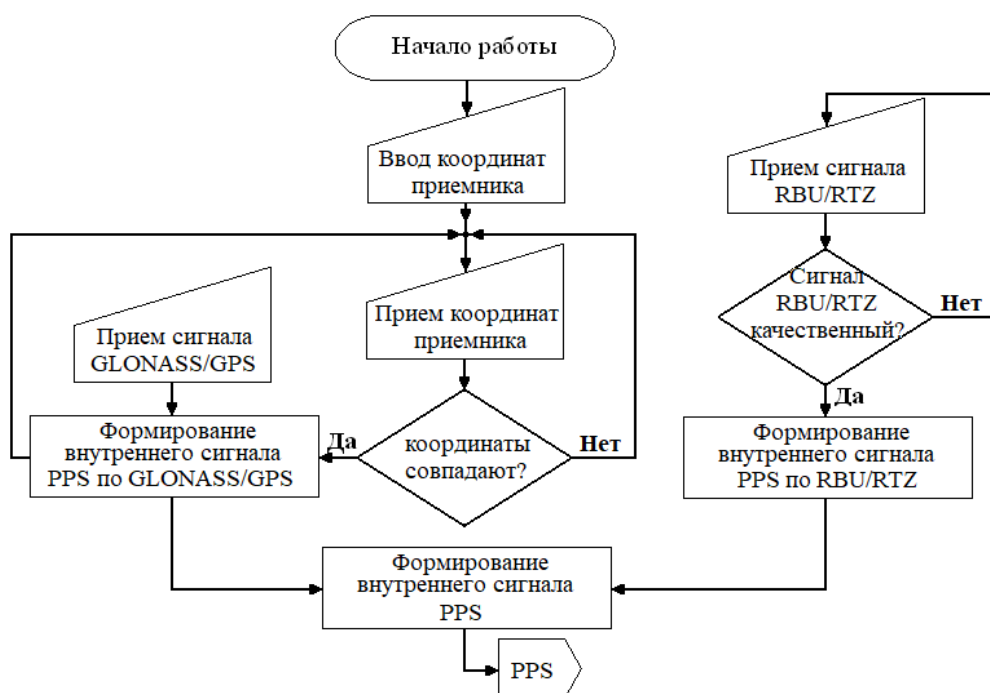
Рис. 5. Блок-схема алгоритма формирования PPS, вырабатываемого на основе принимаемых сигналов СДВ и PPS, вырабатываемых спутниковым приемником GLONASS/GPS
