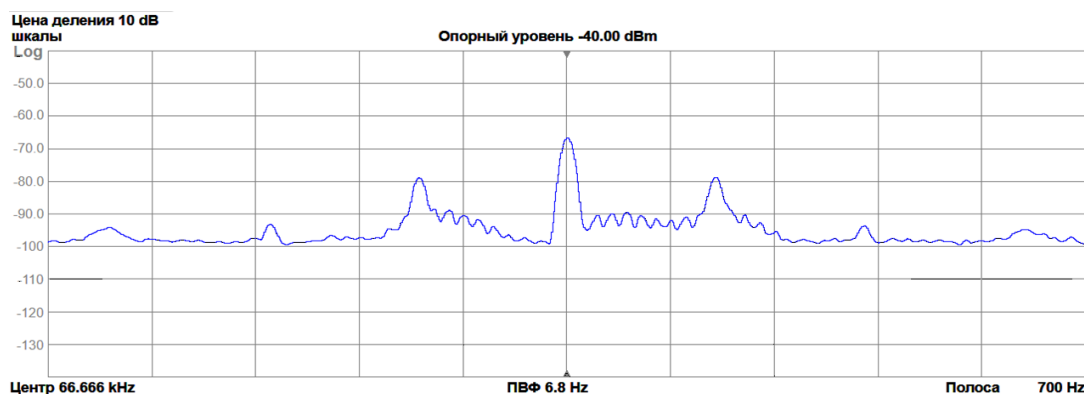
Рис. 2. Спектр частот принимаемых принимаемый активной антенной, настроенной на резонанс 66.(6) кГц, полоса сигнала 700 Гц
