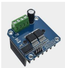
а) драйвер «BTS7960»; б) реле электромагнитное «TRAF-D-5VDC-S-H»
