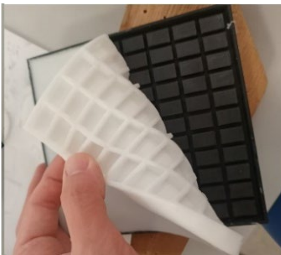
Рисунок 3 – Процесс снятия готовой формы
