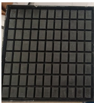
Рисунок 1 – Матрица, напечатанная на 3D-принтере из пластика PLA
