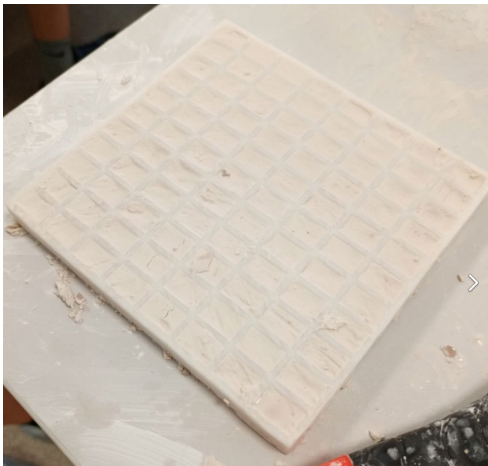
Рисунок 4 – Силиконовая форма, заполненная гипсовой смесью
