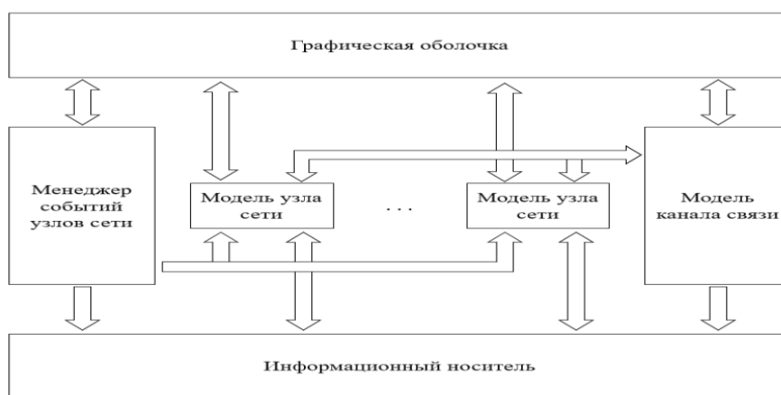
Рисунок 1 – Структура типовой беспроводной сенсорной сети
