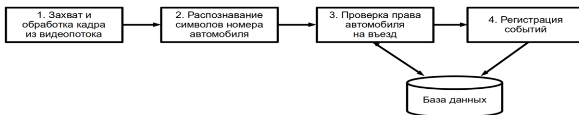
Рисунок 1 – Принцип работы алгоритма для распознавания и автоматического пропуска транспортного средств
