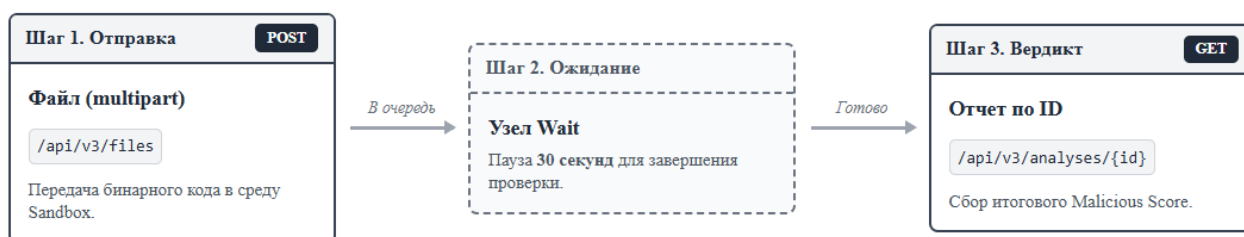
Рисунок 3 – Алгоритм взаимодействия с API VirusTotal при проверке файловых вложений
