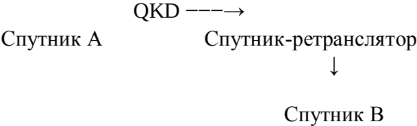
Рисунок 2 – Схема архитектуры межспутниковой квантовой сети
