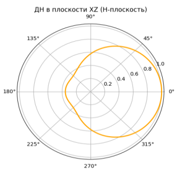
Рисунок 2 – Диаграмма направленности антенны: а - полуволновой диполь, б - только директор, в - только рефлектор
