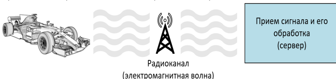
Рисунок 3 – Примерная схема работы мониторинга с помощью датчиков в болиде
