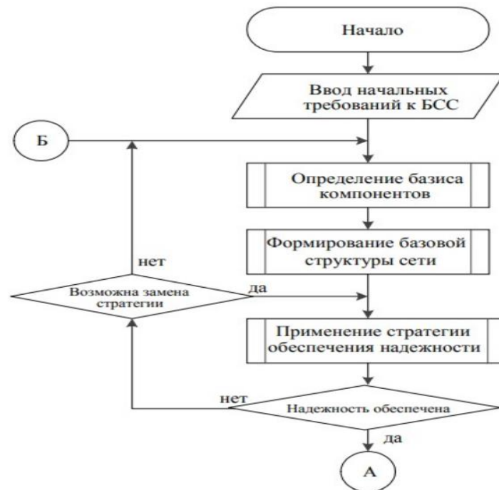
Рисунок 2 - Блок-схема алгоритма для моделирования беспроводных сенсорных сетей со статической топологией узлов
