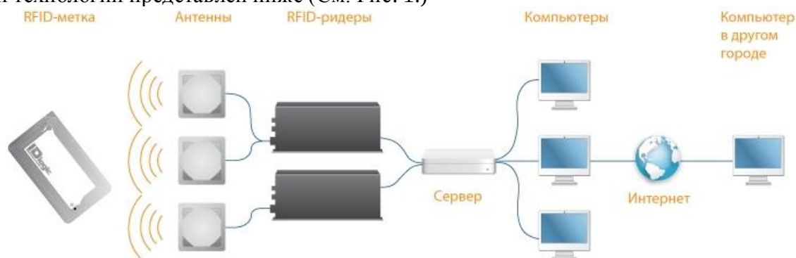
Рисунок 1 – работа RFID-технологии с помощью метки
